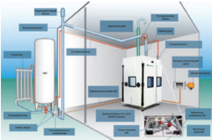
11 Пример размещения установки Qualmark внутри испытательного центра
