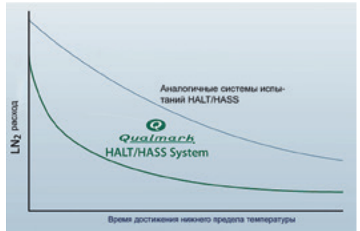
13 Скорость достижения температур. Камера Qualmark уже достигла заданных значений температур и вышла на выдержку, а аналогичные модели только приближаются к ним
